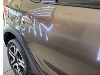
Kapı, sağ arka, Kapı, sağ arka > Çizik
