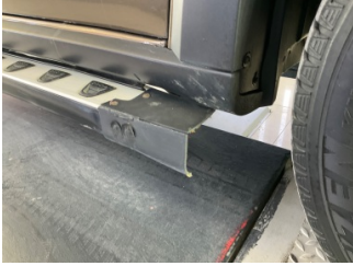
Marşbiyel, sağ, Marşbiyel plastiği, sağ > Hasarlı
