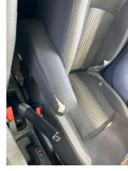
Döşemeler/Kapaklar, Kol dayaması, ön > Hasarlı
