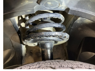
Ön aks, Amortisör körüğü, sol > Hasarlı
