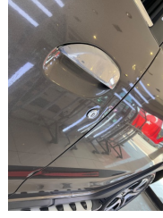
Kapı, sol ön, Kapı, sol ön > Ezik
