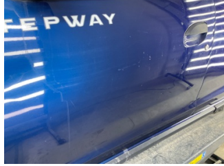
Kapı, sol ön, Kapı, sol > Çizik
