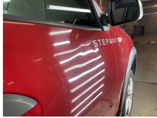
Kapı, sağ ön, Kapı, sağ > Ezik
