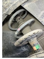
Ön aks, Amortisör körüğü, sağ > Hasarlı
