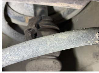
Ön aks, Amortisör körüğü, sol > Hasarlı
