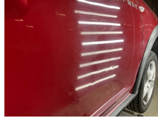
Kapı, sağ ön, Kapı, sağ > Ezik
