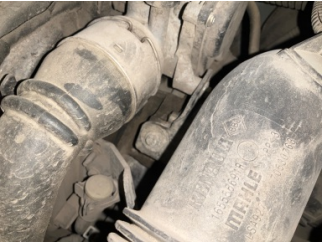
Motor, Turbo hortumları > Yağ Kaçağı
