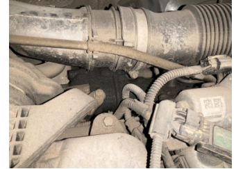
Motor, Turbo hortumları > Yağ Kaçağı
