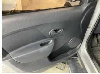
Döşemeler/Kapaklar, Döşemeler/Kapaklar > Deforme Olmuş
