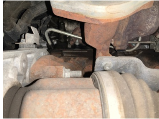
Motor, Turbo hortumları > Yağ Kaçağı
