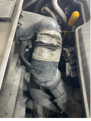
Motor, Hava filtresi > Standart Dışı Onarım
