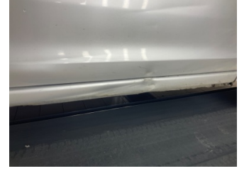
Marşbiyel, sağ, Marşbiyel, sağ > Hasarlı
