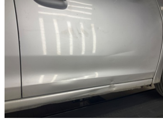
Kapi, sağ ön, Kapi, sağ ön > Hasarlı
