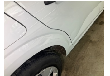
Çamurluk, sağ arka, Çamurluk, sağ arka > Ezik
