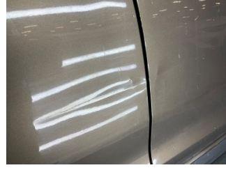
Kapı, sağ arka, Kapı, sağ arka > Ezik
