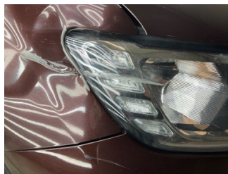
Farlar, Far camı, sağ > Hasarlı
