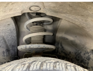
Ön aks, Amortisör körüğü, sağ > Hasarlı
