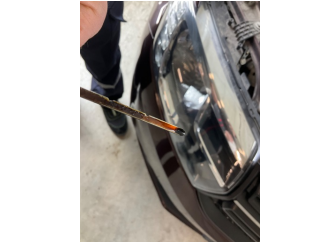
Motor, Yağ seviyesi > Eksik
