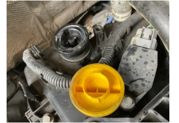
Motor, Yağ kapağı > Kırılmış
