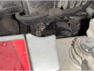
Motorsoğutması, Soğutma sıvısı > Sızdırıyor
