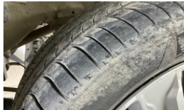
Tekerlek seti > Çatlak
