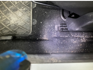
Döşemeler/Kapaklar, Döşemeler/Kapaklar > Yakıcı Madde Ile Zarar Görmüş
