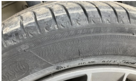
Tekerlek seti > Çatlak
