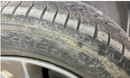
Tekerlek seti > Çatlak
