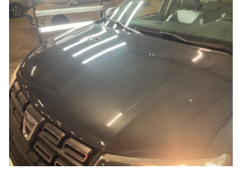
Motor kaputu, Motor kaputu > Dolu Hasarı
