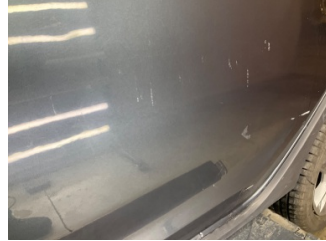
Kapı, sol arka, Kapı, sol arka > Çizik
