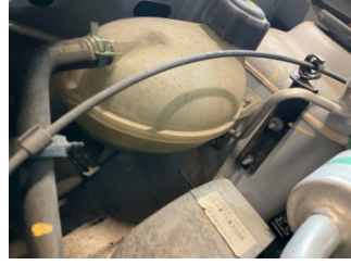
Motorsoğutması, Soğutma sıvısı > Eksik
