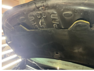
Motor, Kaput izolasyonu > Hasarlı
