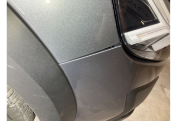
Tampon, ön, Ön tampon > Sabitlemesi Hatalı
