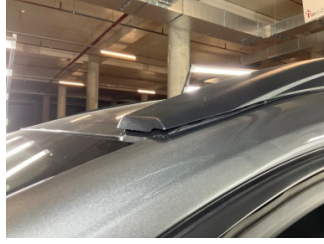
Tavan, Rüzgar engelleyici > Sabitlemesi Hatalı
