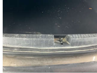
Döşemeler/Kapaklar, Döşemeler/Kapaklar > Deforme Olmuş
