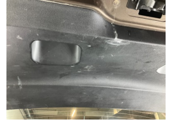
Döşemeler/Kapaklar, Döşemeler/Kapaklar > Deforme Olmuş
