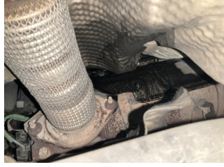
Motor, Turbo hortumları > Yağ Kaçağı
