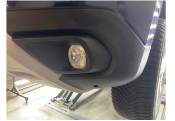
Tampon, ön, Spoiler > Deforme Olmuş
