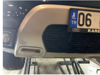
Tampon, ön, Spoiler > Deforme Olmuş
