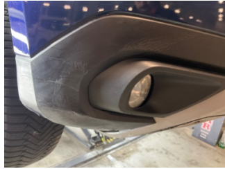
Tampon, ön, Spoiler > Deforme Olmuş
