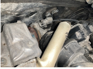
Motor, Turbo hortumları > Yağ Kaçağı
