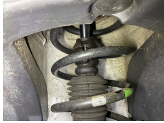
Ön aks, Amortisör körüğü, sol > Hasarlı
