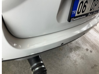
Tampon, arka, Arka tampon > Çatlak
