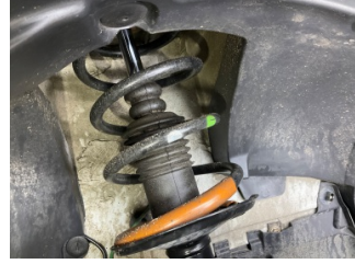
Ön aks, Amortisör körüğü, sağ > Hasarlı
