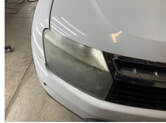
Farlar, Far camı, sağ > Deforme Olmuş
