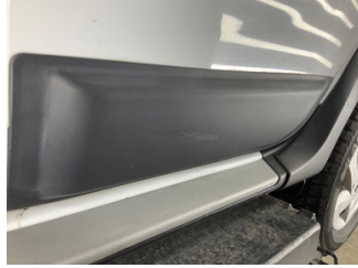
Kapı, sol arka, Kapı bandı > Çizik
