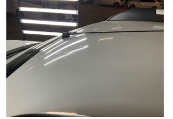
Tavan, Tavan > Dolu Hasarı
