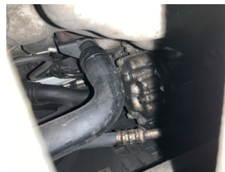
Motor, Motor > Yağ Kaçağı
