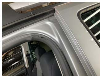
Kapı, sol ön, Kapı fitili > Hasarlı
