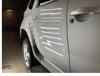
Kapı, sağ arka, Kapı, sağ arka > Ezik
