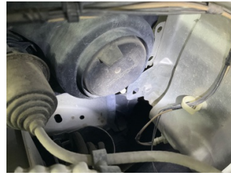
Çamurluk, sağ, Bağlantı ayağı > Ezik
