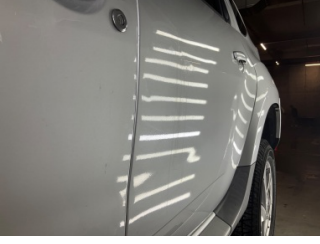
Kapı, sol arka, Kapı, sol arka > Vuruk
