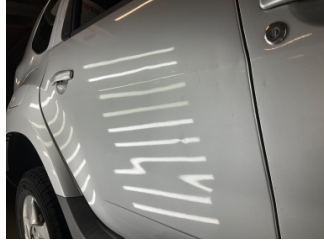
Kapı, sağ arka, Kapı, sağ arka > Vuruk
