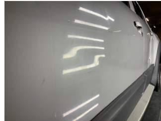
Kapı, sol ön, Kapı, sol ön > Ezik
