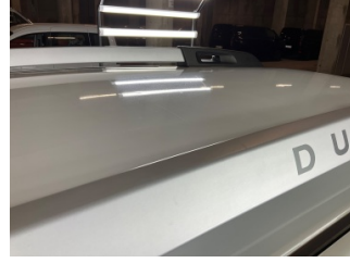
Tavan, Tavan > Dolu Hasarı
