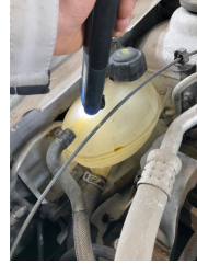
Motorsoğutması, Soğutma sıvısı > Eksik
