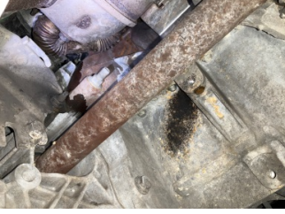
Motorsoğutması, Soğutma sıvısı > Sızdırıyor
