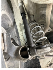
Arka aks, Amortisör, arka > Yağ Kaçağı
