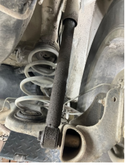
Arka aks, Amortisör, arka > Yağ Kaçağı
