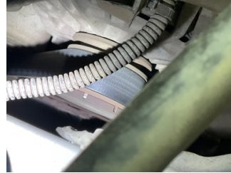
Motorsoğutması, Kayış > Çatlak
