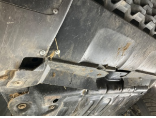
Tampon, ön, Tampon koruyucu orta > Hasarlı
