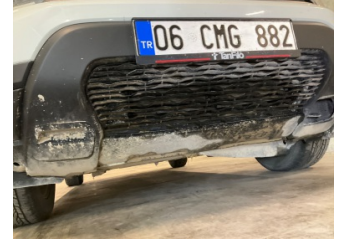
Tampon, ön, Çeki demir kapağı > Sökülmüş-Yok
