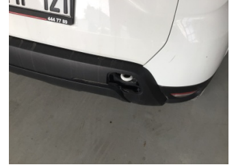
Tampon, arka, Çeki demir kapađı > Sökülmüş-Yok
