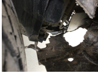
Motor, Alt muhafaza > Deforme Olmuş
