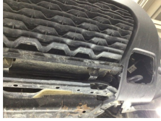
Tampon, ön, Ön tampon > Kırılmış
