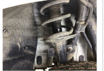
Arka aks, Amortisör, arka sağ > Yağ Kaçağı
