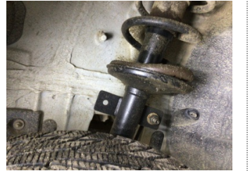
Arka aks, Amortisör, arka sol > Yağ Kaçağı
