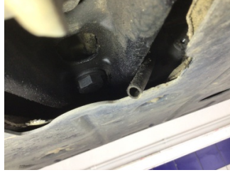
Şanzıman, Şanzıman > Yağ Kaçağı
