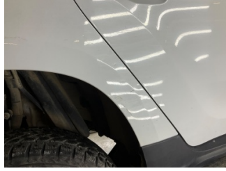
Çamurluk, sağ arka, Çamurluk, sağ arka > Ezik
