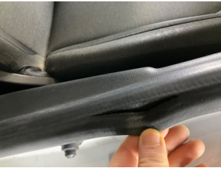
Kapı, sol ön, Kapı fitili > Hasarlı
