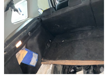
Döşemeler/Kapaklar, Pandizot > Sökülmüş-Yok
