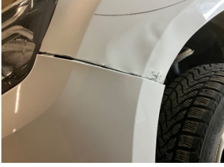
Tampon, ön, Ön tampon > Sabitlemesi Hatalı
