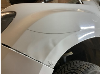
Çamurluk, sol, Çamurluk, sol > Hasarlı
