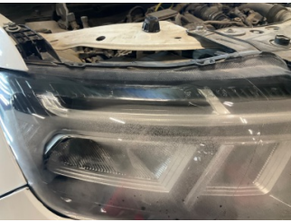
Farlar, Far camı, sağ > Deforme Olmuş
