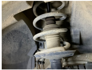
Ön aks, Amortisör körüğü, sağ > Hasarlı
