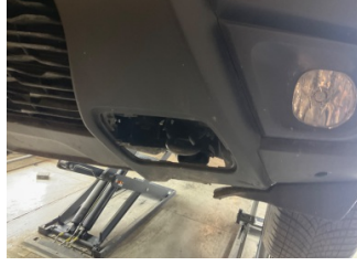
Tampon, ön, Çeki demir kapağı > Sökülmüş-Yok
