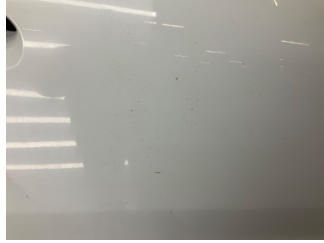
Kapı, sağ ön, Kapı, sağ ön > Pas
