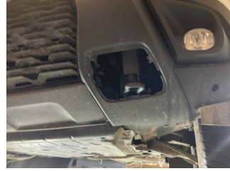
Tampon, ön, Çeki demir kapağı > Sökülmüş-Yok
