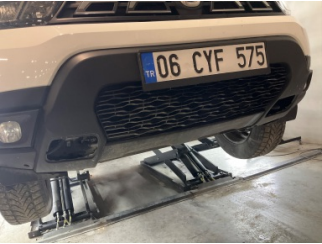
Tampon, ön, Çeki demir kapağı > Sökülmüş-Yok
