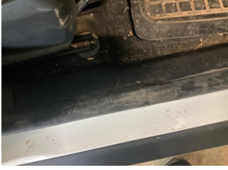
Kapı, sağ ön, Kapı fitili > Deforme Olmuş
