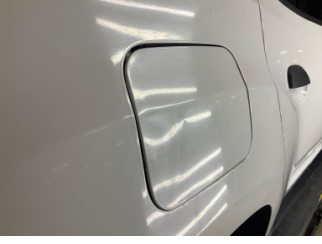
Çamurluk, sağ arka, Yakıt deposu kapağı > Ezik
