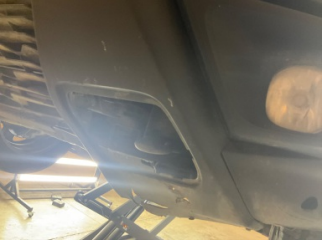
Tampon, ön, Çeki demir kapağı > Sökülmüş-Yok
