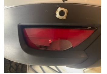
Tampon, arka, Reflektör, sol > Hasarlı
