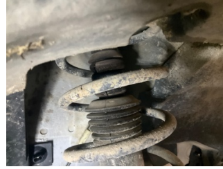
Ön aks, Amortisör körüğü, sağ > Hasarlı
