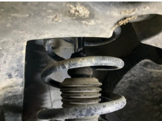
Ön aks, Amortisör körüğü, sol > Hasarlı
