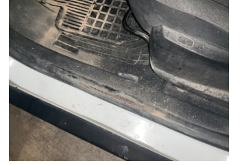
Kapı, sol ön, Kapı fitili > Hasarlı
