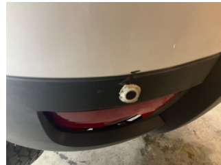
Tampon, arka, Park sensörü, sol > Hasarlı
