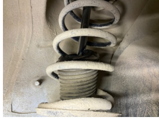
Arka aks, Amortisör körüğü, sol > Hasarlı
