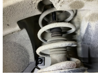
Ön aks, Amortisör körüğü, sağ > Hasarlı
