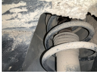
Ön aks, Amortisör körüğü, sağ > Hasarlı
