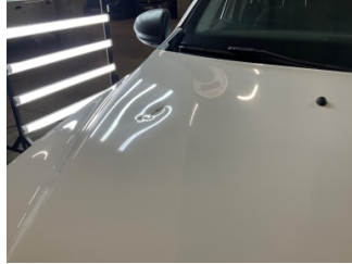
Motor kaputu, Motor kaputu > Hasarlı
