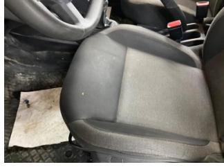
Döşemeler/Kapaklar, Döşemeler/Kapaklar > Yakıcı Madde Ile Zarar Görmüş
