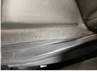
Döşemeler/Kapaklar, Döşemeler/Kapaklar > Dikişleri Açılmış
