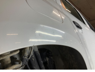
Çamurluk, sağ arka, Çamurluk, sağ arka > Ezik
