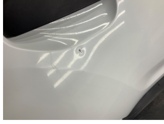
Kapı, sağ arka, Kapı, sağ arka > Ezik
