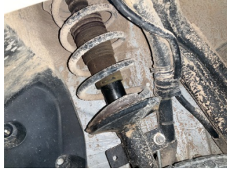
Arka aks, Amortisör, arka > Yağ Kaçağı
