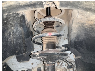
Ön aks, Amortisör körüğü, sol > Yağ Kaçağı
