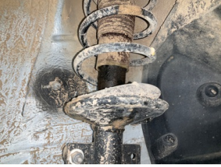
Arka aks, Amortisör, arka > Yağ Kaçağı
