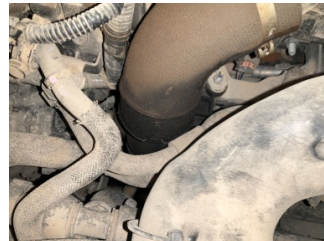
Motor, Turbo hortumları > Yağ Kaçağı
