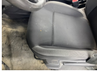
Döşemeler/Kapaklar, Döşemeler/Kapaklar > Yakıcı Madde Ile Zarar Görmüş
