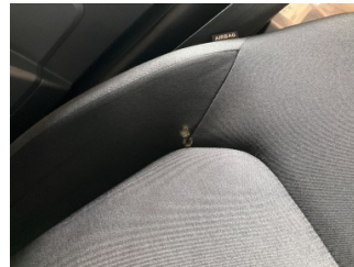
Döşemeler/Kapaklar, Döşemeler/Kapaklar > Yakıcı Madde Ile Zarar Görmüş
