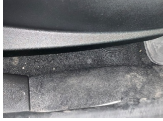
Döşemeler/Kapaklar, Döşemeler/Kapaklar > Yakıcı Madde ile Zarar Görmüş
