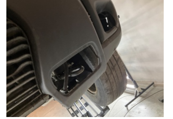
Tampon, ön, Çeki demir kapağı > Sökülmüş-Yok
