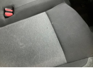
Döşemeler/Kapaklar, Döşemeler/Kapaklar > Yakıcı Madde ile Zarar Görmüş
