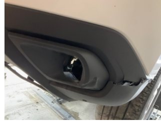
Sis lambaları, Sis farı, sol > Sökülmüş-Yok
