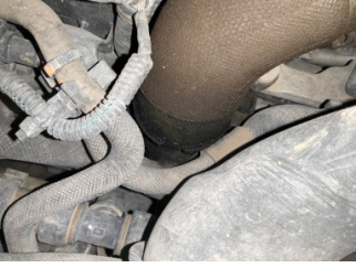
Motor, Turbo hortumları > Yağ Kaçağı
