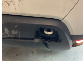
Tampon, arka, Çeki demir kapağı > Sökülmüş-Yok
