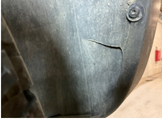
Çamurluk, sağ, Davlumbaz > Kırılmış
