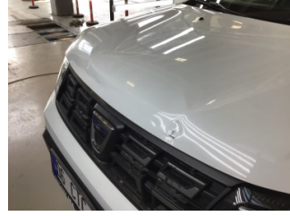
Motor kaputu, Motor kaputu > Hasarlı
