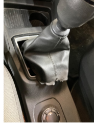
Şanzıman, Vites körüğü > Hasarlı
