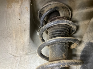
Arka aks, Amortisör körüğü, sol > Hasarlı
