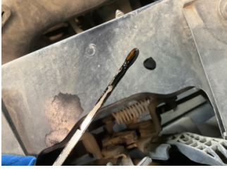
Motor, Yağ seviyesi > Eksik
