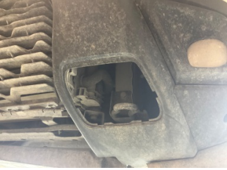
Tampon, ön, Çeki demir kapağı > Sökülmüş-Yok
