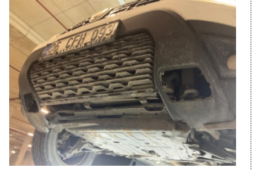
Tampon, ön, Tampon koruyucu orta > Sökülmüş-Yok
