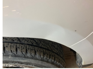
Çamurluk, sağ, Çamurluk, sağ > Hasarlı
