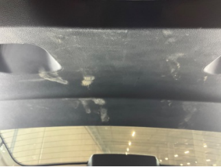
Döşemeler/Kapaklar, Döşemeler/Kapaklar > Çizik
