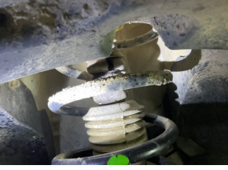
Ön aks, Amortisör körüğü, sol > Hasarlı
