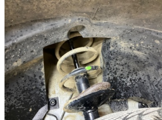
Ön aks, Amortisör körüğü, sağ > Sökülmüş-Yok
