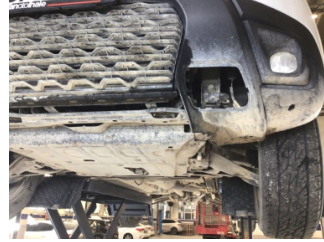
Tampon, ön, Çeki demir kapağı > Sökülmüş-Yok
