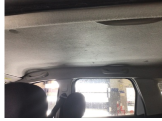
Döşemeler/Kapaklar, Tavan döşemesi > Kirlenmiş
