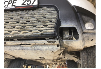
Tampon, ön, Spoiler > Hasarlı
