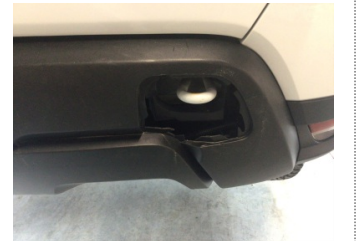
Tampon, arka, Çeki demir kapağı > Sökülmüş-Yok
