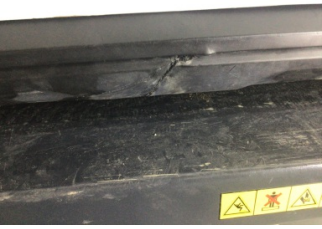
Marşbiyel, sol, Marşbiyel plastiği, sol > Hasarlı
