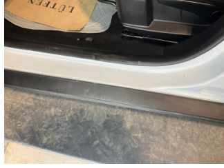
Marşbiyel, sol, Marşbiyel, sol > Boyası Atmış
