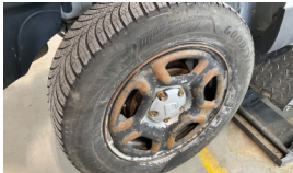
Jant, sağ arka > Deforme Olmuş
