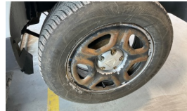
Jant, sol arka > Deforme Olmuş
