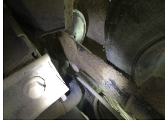
Arka aks, Amortisör, arka sağ > Yağ Kaçağı
