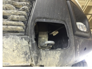
Tampon, ön, Çeki demir kapağı > Sökülmüş-Yok
