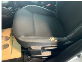
Koltuklar, ön, Koltuk arkılığı döşemesi, sol ön > Hasarlı
