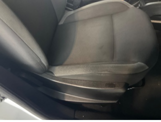
Koltuklar, ön, Koltuk arkılığı döşemesi, sağ ön > Deforme Olmuş
