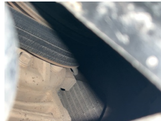
Motorsöğütması, Kayış > Deforme Olmuş
