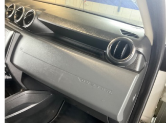
Döşemeler/Kapaklar, Döşemeler/Kapaklar > Deforme Olmuş
