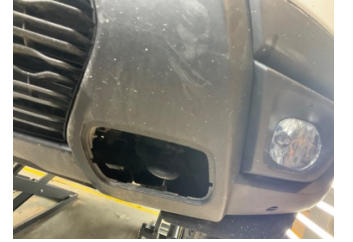
Tampon, ön, Çeki demir kapağı > Sökülmüş-Yok
