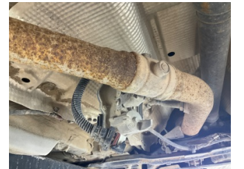
Egzoz sistemi, Egzoz sistemi > Hasarlı
