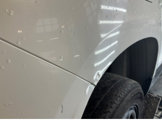
Çamurluk, sağ arka, Çamurluk, sağ arka > Ezik
