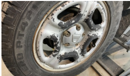
Jant, sağ arka > Deforme Olmuş
