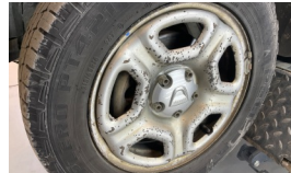
Jant kapağı, sol ön > Deforme Olmuş
