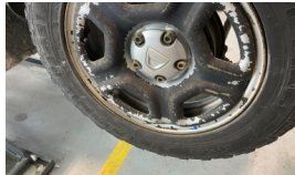
Jant, sol arka > Deforme Olmuş
