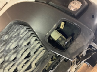
Tampon, ön, Çeki demir kapağı > Sökülmüş-Yok
