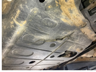
Motor, Alt muhafaza > Hasarlı
